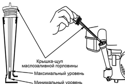
Рис. 7 Проверка уровня масла в картере
